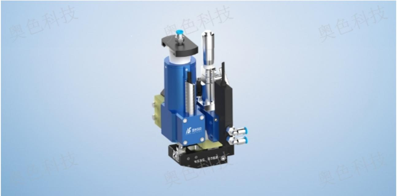
气动配料阀由气缸、阀体、料缸上下连接而成。气缸与阀体之间采用先进的密封材料隔开，防止胶水侵入气缸。料缸和气缸连接在点胶阀主体上，保证与气缸同心度。利用电磁阀的气缸运动，从而带动中心杆上下运动，利用中心杆的上下运动实现胶水的启闭。按启闭方式的不同，可分为柱塞式点胶阀、顶针式点胶阀、提升式点胶阀、喷雾点胶阀和喷射式点胶阀；不同的开关方式有不同的适用流体(胶水)。回吸式点胶阀采用向上运动关胶结构，使胶停止，同时瞬间将胶吸回切断，减少剩余针上的残胶，防止滴胶、拉丝等现象。胶阀体采用铝合金阳极氧化处理，密封材料为四氟材料，与胶体接触的部分为耐腐蚀材料。上海奥色智能科技有限公司主营PUR热熔胶点胶阀，若有需要欢迎来电垂询。广东高精密点胶阀参数
